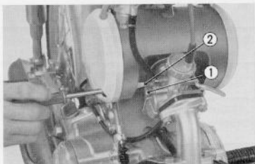
Fig. 6.2 Adjusting the Idling (S 90)
